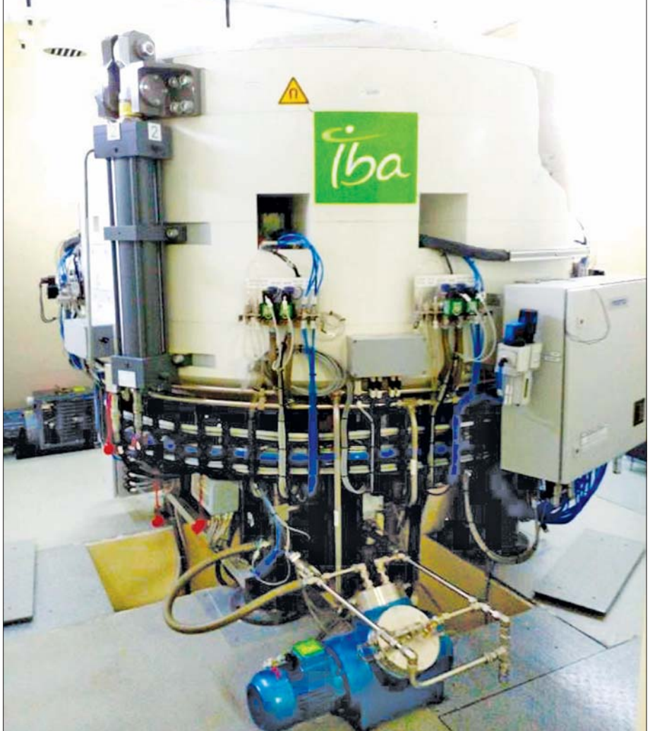
ရန်ကုန်ပြည်သူ့ဆေးရုံကြီး၌ တပ်ဆင်ထားရှိသော Cyclotron စက်ကို တွေ့ရစဉ်။
