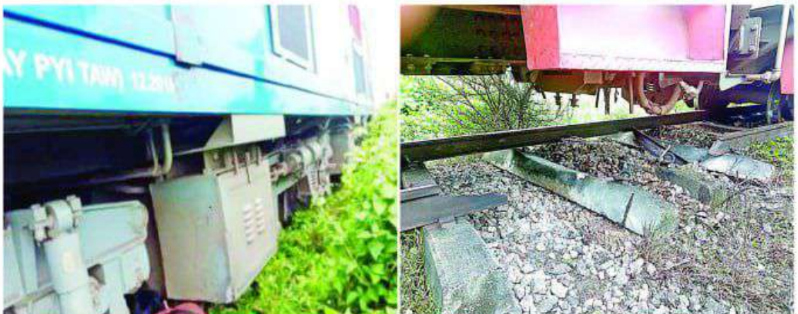
အကြမ်းဖက်သောင်းကျန်းသူအဖွဲ့က မိုင်းပောက်ခွဲဖျက်စီးခဲ့သဖြင့် ရထားလမ်းပျက်စီးပြီး ပဲခူး-မော်လမြိုင်လမ်းပိုင်း သိမ်ဆိပ်ဘူတာနှင့်ဒုံဝန်းဘူတာကြား အမှတ်(၈၂)အစုန် လူစီးအမြန်ရထားလမ်းချော့ကျနေမှုကို တွေ့ရစဉ်။
