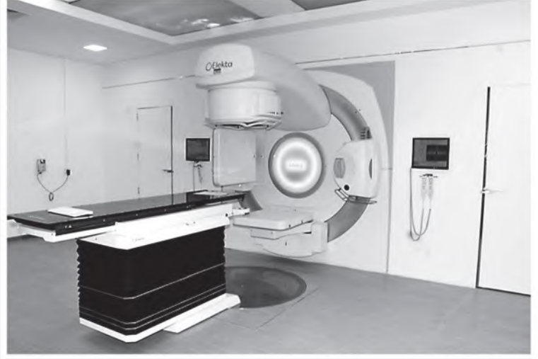
မန္တလေးပြည်သူ့ဆေးရုံကြီး၏ ၂၀၂၃ ခုနှစ်၊ အောက်တိုဘာလတွင် အသစ်တပ်ဆင်ထားသော ဓာတ်ရောင်ခြည်ကုသစက် (Elekta Infinity-LA)
