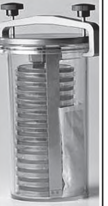
သိုးသွေးဖြင့် ပြုလုပ်ထားသော ပိုးပျိုးစာ (Blood agar) ကို Anaerobic jar တွင် ထည့်၍ ပိုးပေါက်စေခြင်း
