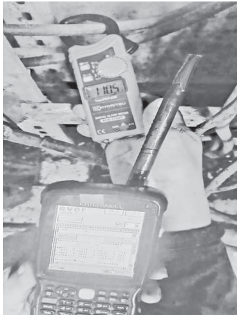
ကွင်းဆင်းစစ်ဆေးရာတွင် လျှပ်စစ်မီးခိုးယူထားမှုအား စစ်ဆေးတွေ့ရှိရပုံ
