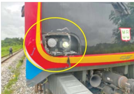
သောင်းတိုင်ကုန်းနှင့် တောင်ငူဘူတာအကြား အမှတ်(၇)အဆန် DEMU ရထားနှင့် ဘေးတွဲဆိုင်ကယ်ပွတ်တိုက်မှုကြောင့် ရထားရှေ့စက်ခေါင်းမီးလုံးကွဲအက်ခြင်း၊ ဆေးပွန်းခြင်းဖြစ်ပွားခဲ့မှုကို တွေ့ရစဉ်။
