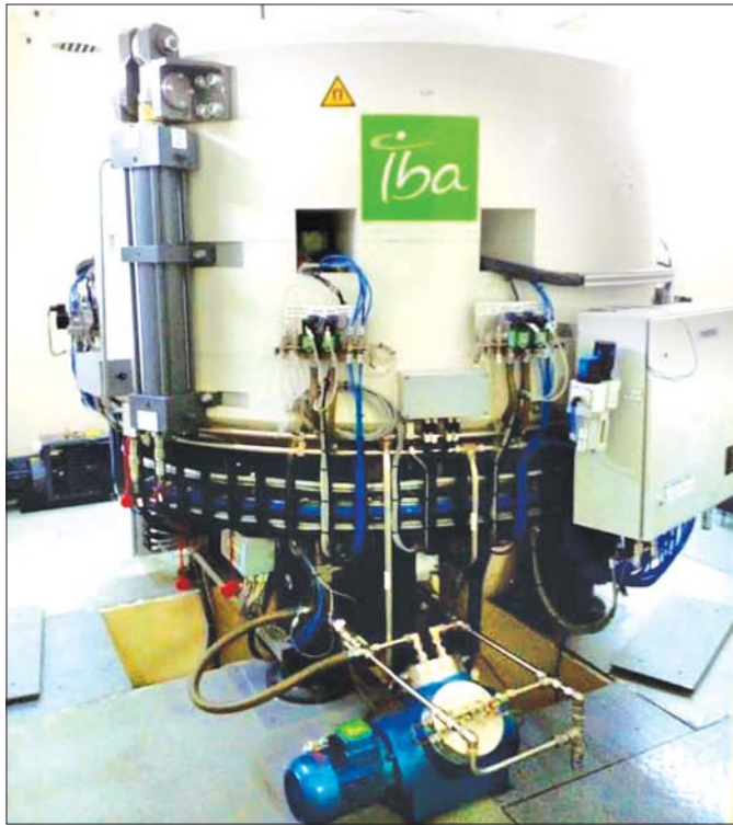
ရန်ကုန်ပြည်သူ့ဆေးရုံကြီး၌ တပ်ဆင်ထားရှိသော Cyclotron စက်။
